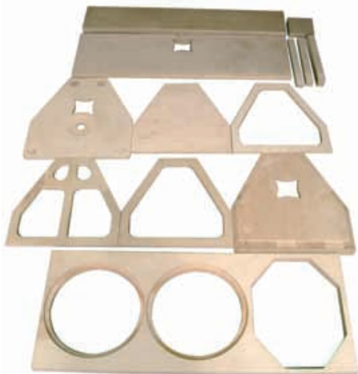
CNC-gefräster Gehäusebausatz aus 15 mm Birken-Multiplex (Foto 3)
